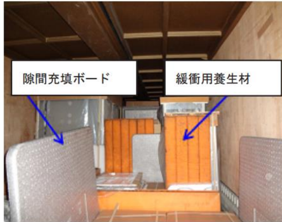
写真3 隙間充填ボードと緩衝用養生材による養生
