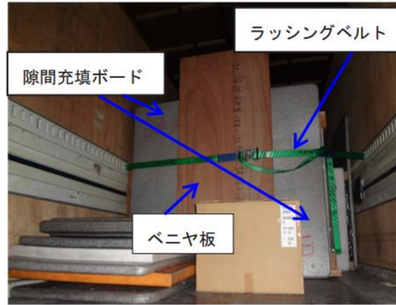
写真4 隙間充填ボードとラッシングベルトによる養生
